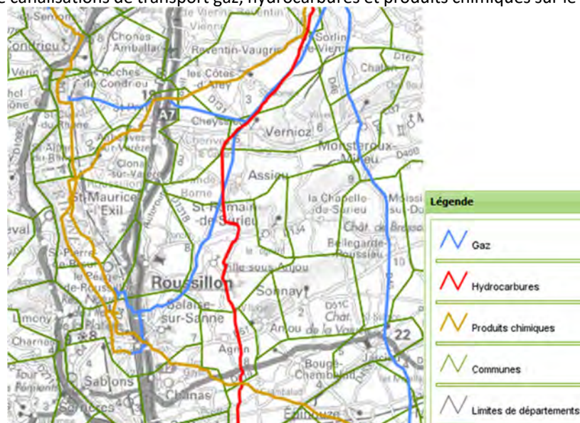
Figure n°86. Carte canalisations de transport gaz, hydrocarbures et produits chimiques sur le Pays Roussillonnais
