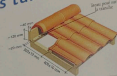
Faîtière 1/2 ronde à emboîtement grand modèle et tuile sous-faîtière 3/4 pureau.
