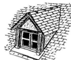
Fig. 9 Lucarne jacobine, en bâtière ou à chevalet
