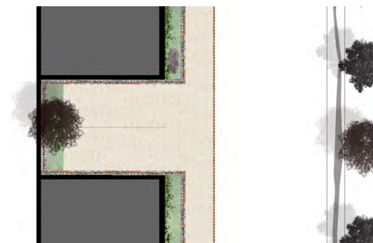
Exemple de stationnement à l'intérieur des parcelles pour logements individuels
