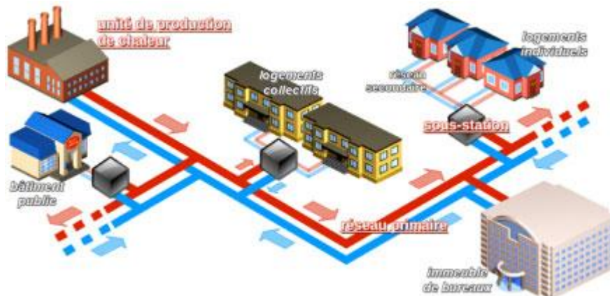
Figure n°87. Fonctionnement réseau de chaleur
